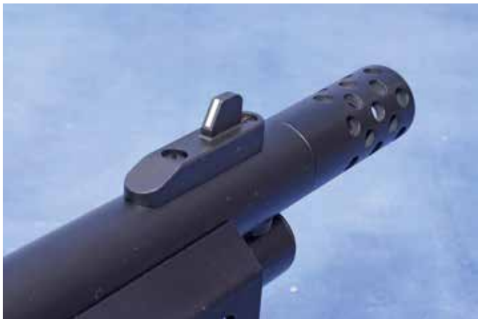
Die mechanische Visierung mit Ghost-Ring-Kimme und Korn mit Balkeneinlage. In der originalen US-Version besitzt das Korn einen Fiberstab und einen integrierten Tritium-Ring.
