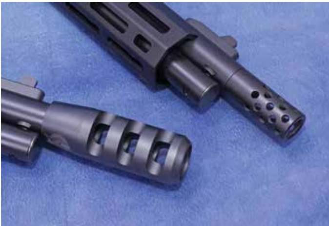
Vergleich der werksseitig montierten Original-Mündungsbremse (oben) im Vergleich zum Hauck-Kompensator (unten), der mit seinen drei großen Expansionskammern und Prallflächen ganze Arbeit leistet.
