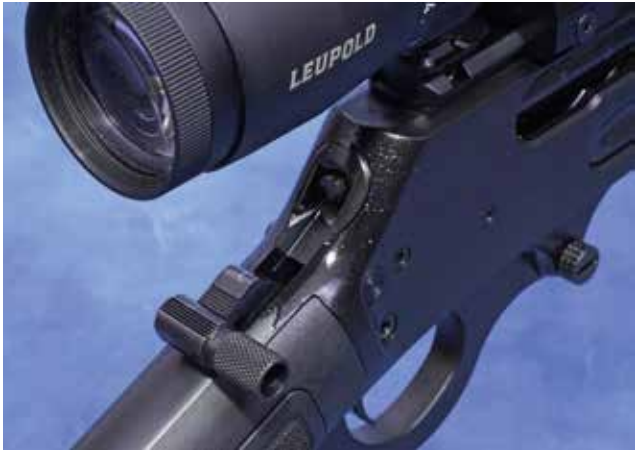
Der Büchsenmachermeister modifizierte den Hammer dergestalt, dass er sich auch bei tiefmontierter Optik bestens bedienen lässt.
