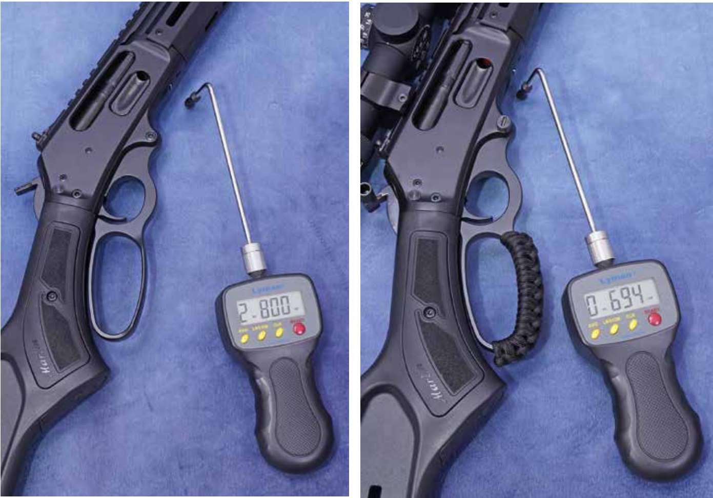
Der werksseitige und der von Hauck überarbeitete Abzug im Vergleich. Eine Abzugsgewichtsreduzierung von rund 2.100 Gramm (!) bei verbesserter Charakteristik sind die erfreulichen Ergebnisse der Bemühungen.
