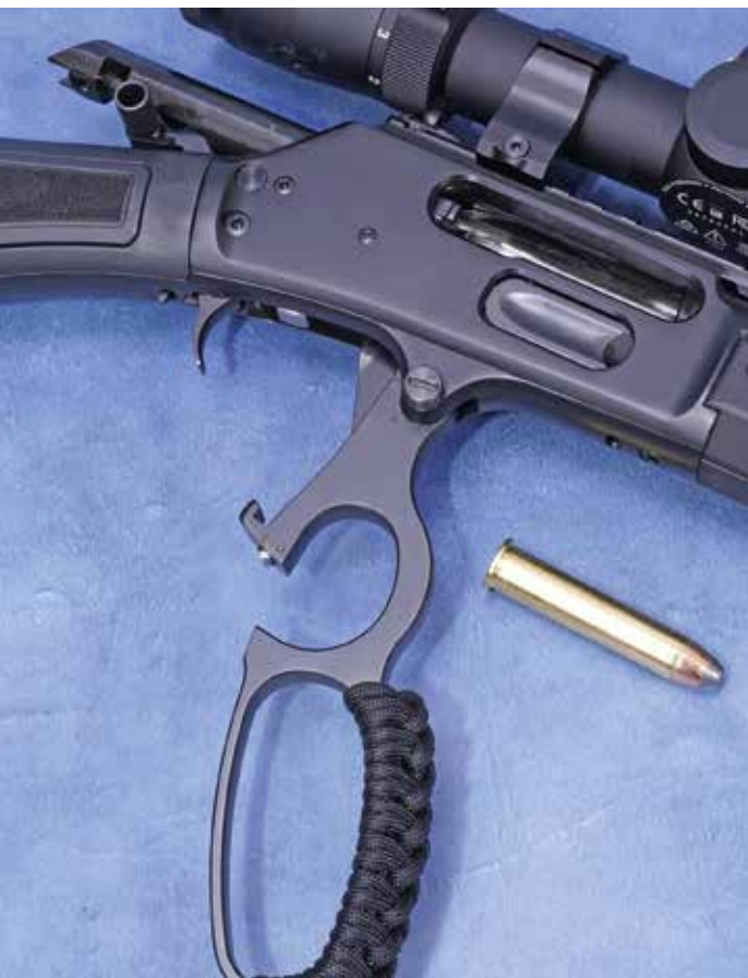
Bei der Hauck-Custom wurde die Unterhebelrepetiermechanik perfekt überarbeitet, was für leichtgängige, geschmeidige Handhabungsabläufe sorgt.
