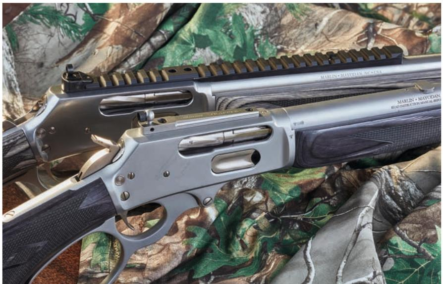
Die Version 1895 SBL kommt mit Pica Rail (o., hier noch mit einer Vorversion dieser Schiene), die Variante 1895 Trapper mit Visier-Schiene von Skinner Optics.
