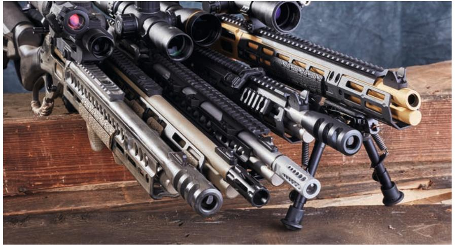
Zwei der fünf mit Blick auf einen taktischen Look getunte Rifles mit Hauck-Bremsen (l., 4.v.l.), eine mit Wilson-Dämpfer (2.v.l.), eine mit Next-Armament-Dämpfer (3.v.l.). Ganz rechts wurde der Lauf schräg gekappt und hinterschnitten.
