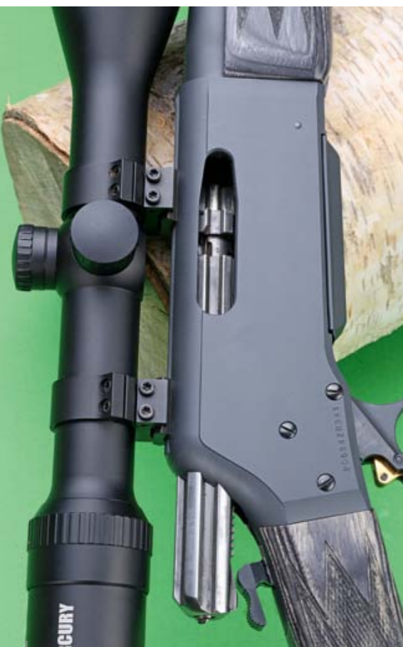
Hinten raus: Der Sechs-Warzen-Verschuss mit Drehkopf spannt beim Repetieren auch den außenliegenden Hahn.
